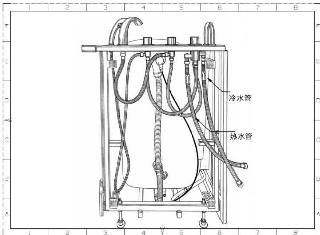
考虑到浴缸整体的包装运输，水龙头一般由客户自行安装，在工厂已预先打好孔的龙头安装位上。在入户安装时只需把冷热水管接在浴室内提前预留好的冷热水龙头上！
