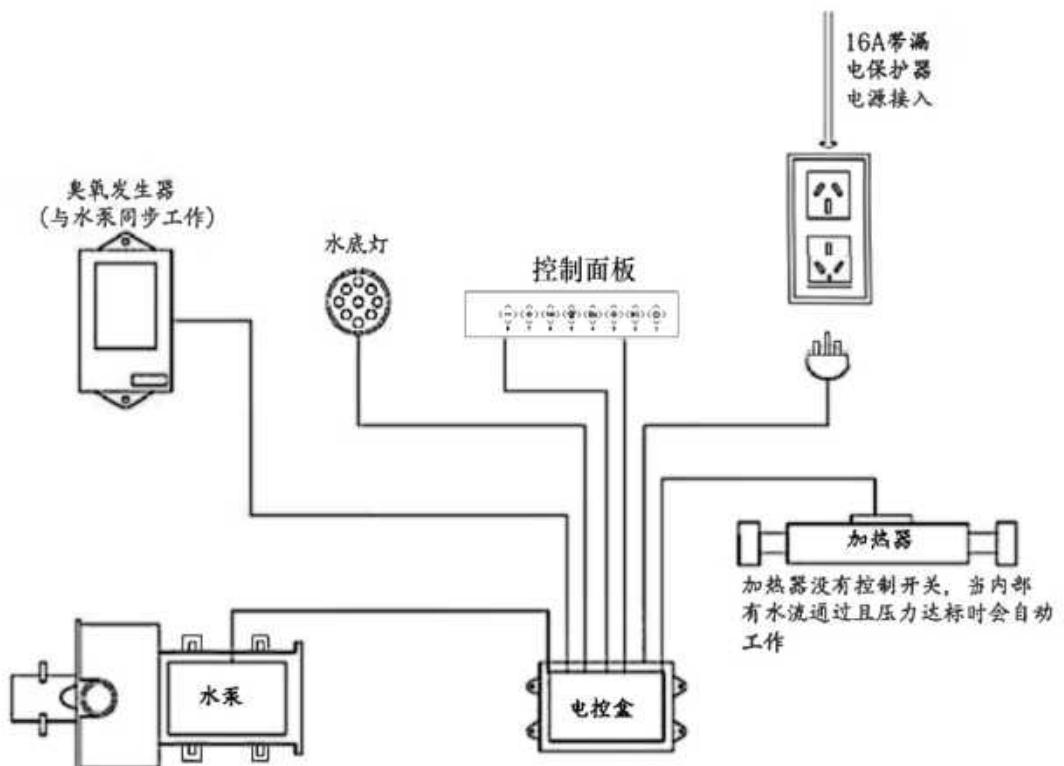
注意：所有电气连接工作必须由持有电工证的专业人员操作，电源必须是 220V 电压，线材必须是 16A 以上的三芯国标线。电源必须接有漏电保护器！
