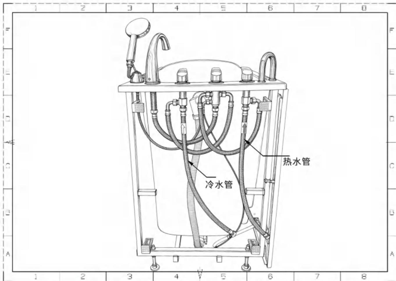
考虑到浴缸整体的包装运输，水龙头一般由客户自行安装，在工厂已预先打好孔的龙头安装位上。在入户安装时只需把冷热水管接在浴室内提前预留好的冷热水龙头上！
